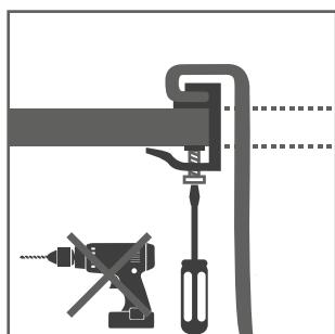
**ПРИМЕЧАНИЕ.** Не используйте электрические и пневматические отвертки без регуляторов нагрузки.
